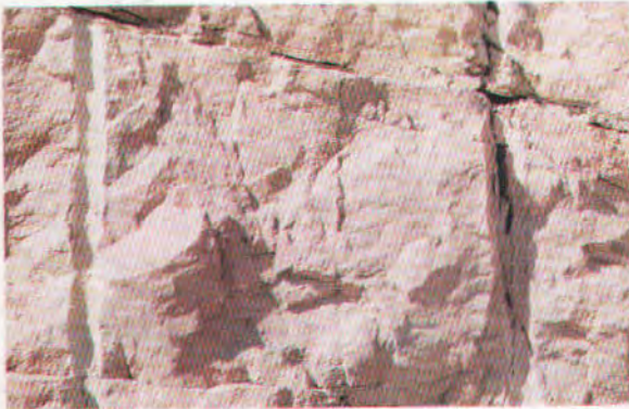
(٣٩) (جبل الحرم) صورة لأحد أجزاء الصخور الشرقية المطلة على التجويف الكبير لجبل الحرم الأكبر وتظهر بعض حفر الألغام النارية التي استخدمت في عملية التكسير.
